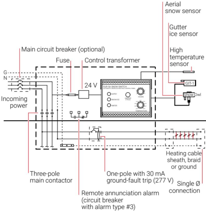
**Figure 6: SMPG wiring diagram**
